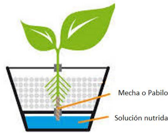
Figura 5. Técnica de mecha o pabito aplicado a una planta. Adaptado de Verdegen (2017)
