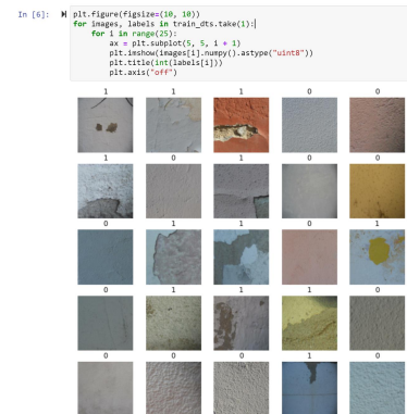
Fig. 2 Muestra de 25 imágenes del conjunto de entrenamiento, etiquetadas automáticamente como positivas (1) y negativas (0).
