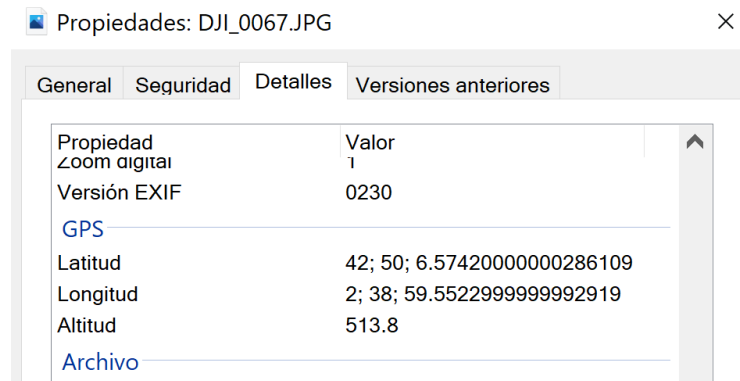
Fig. 22 Muestra, en las propiedades internas de una de las imágenes proporcionadas por el dron, de las coordenadas gps y altura en el instante de realizar la toma.
