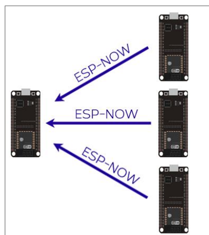
Figura 9. Receptor de mensajes con ESP-NOW.
