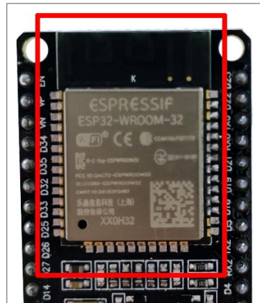
Figura 13. ESP32 versión WROOM-32 montado sobre placa de desarrollo.
