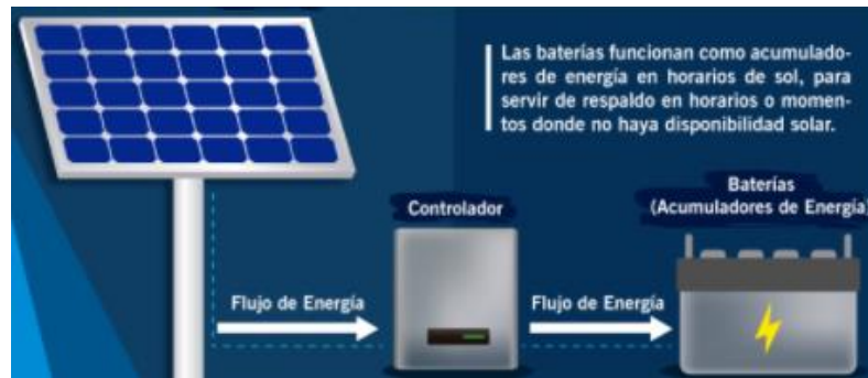
Figura 16. Importancia de las baterías en los sistemas fotovoltaicos. (Ingeniería y construcciones HG, 2019).
