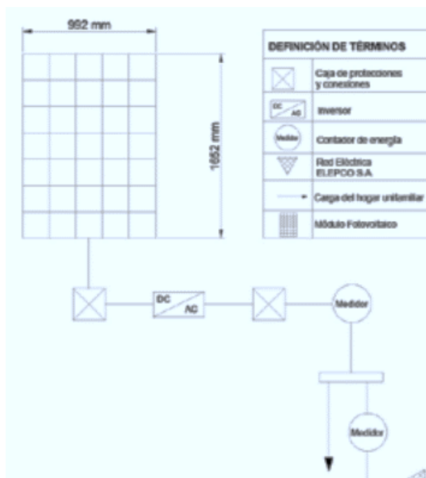
Figura 3. Diagrama del Sistema Fotovoltaico utilizado en un domicilio. (Proaño, 2014).
