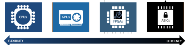
Figura 5. Alternativas de HW para soluciones de ML y DL (Jawandhiya, 2018).
