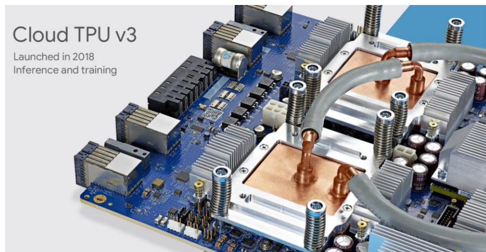
Figura 7. Hardware propuesto por Google Cloud Platform para modelos de ML y DL – Cloud TPU v3 (Sato, 2018).
