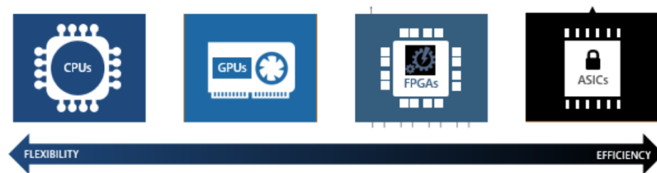
Figura 5. Alternativas de HW para soluciones de ML y DL (Jawandhiya, 2018).
