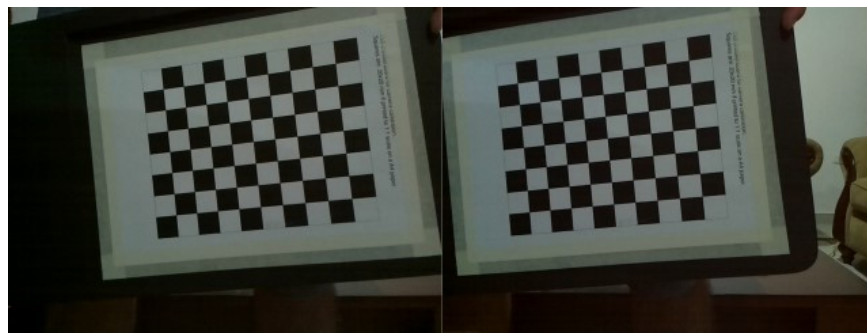
Figura 15. Captura estéreo del patrón de ajedrez para calibración.
