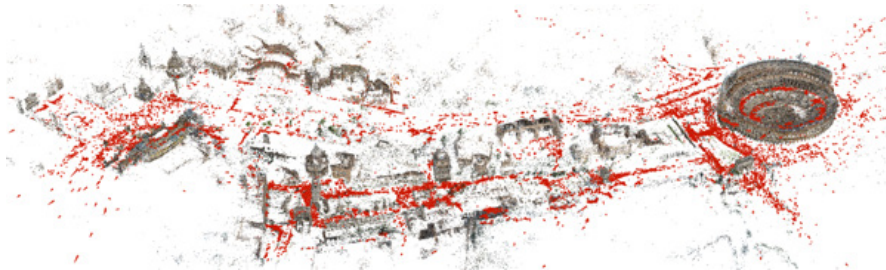
Figura 30. Modelo poco denso del centro de Roma usando 21K fotos, obtenido con COLMAP's SfM pipeline. Recuperado de https://colmap.github.io/index.html
