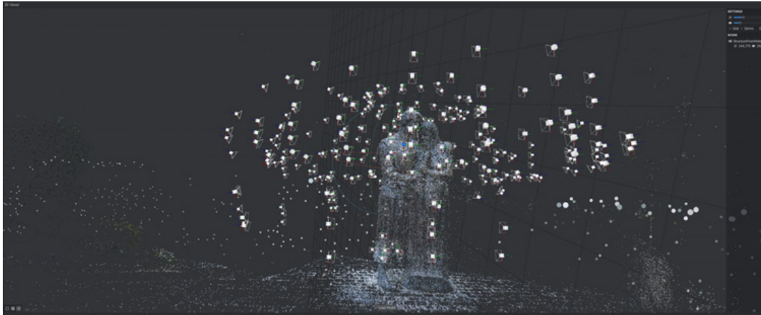
Figura 263. Utilización del programa Meshroom. Nube de puntos. (Elaboración propia.)
