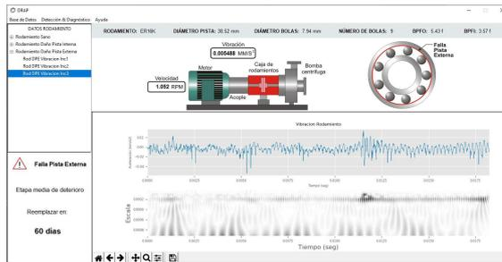
Figura 12. Pantallazo del sistema desarrollado con diagnóstico integral de la condición Falla en Pista Externa del rodamiento.
