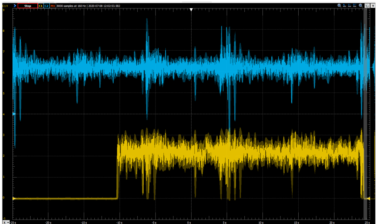
Figura 47: Inicio de adquisición con procesamiento ‘on-the-edge’, señal original [azul] y señal filtrada [amarillo] (Fuente Propia)
