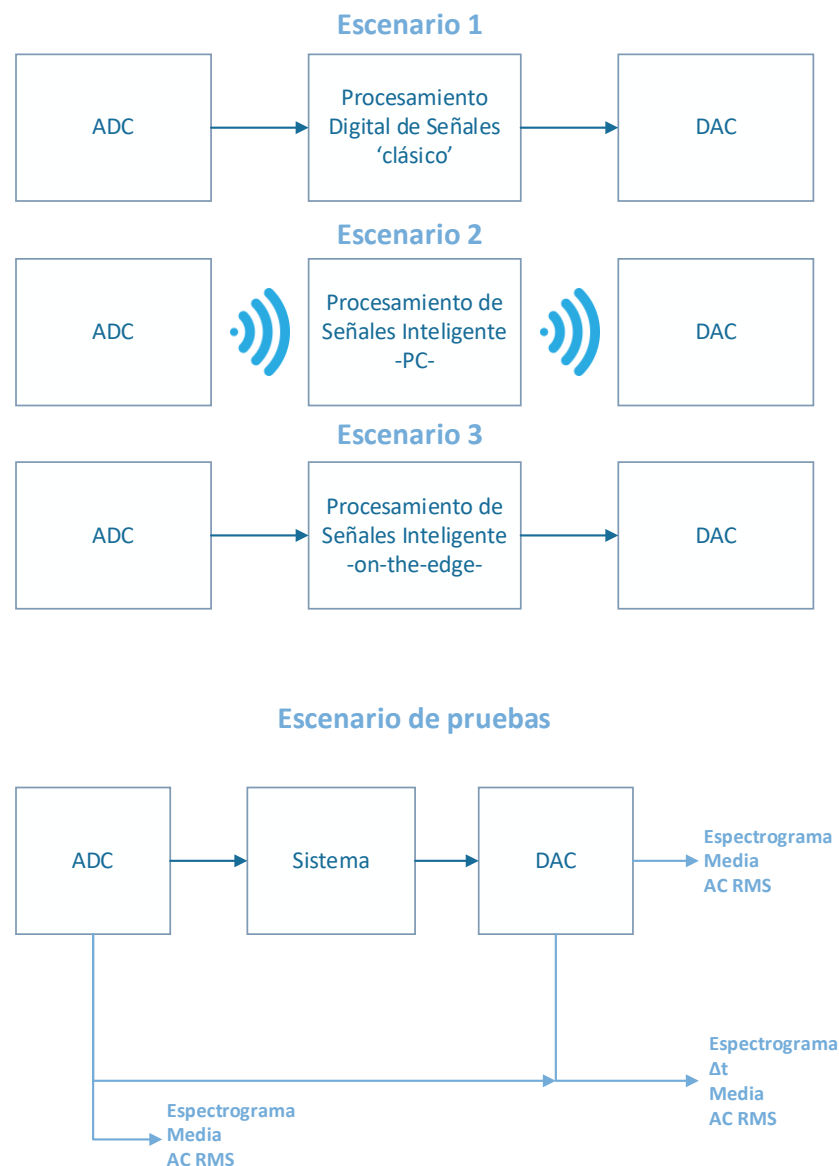
Figura 1. Escenario de pruebas para la comparativa de los sistemas de procesamiento (Fuente Propia)
