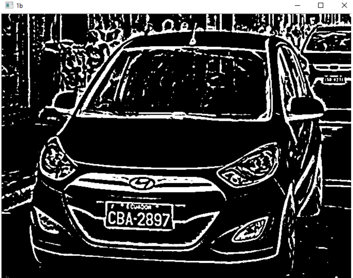
Figura 26. Threshold de la imagen original
