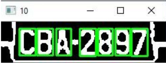
Figura 29. Segmentación y comparación de los caracteres.
