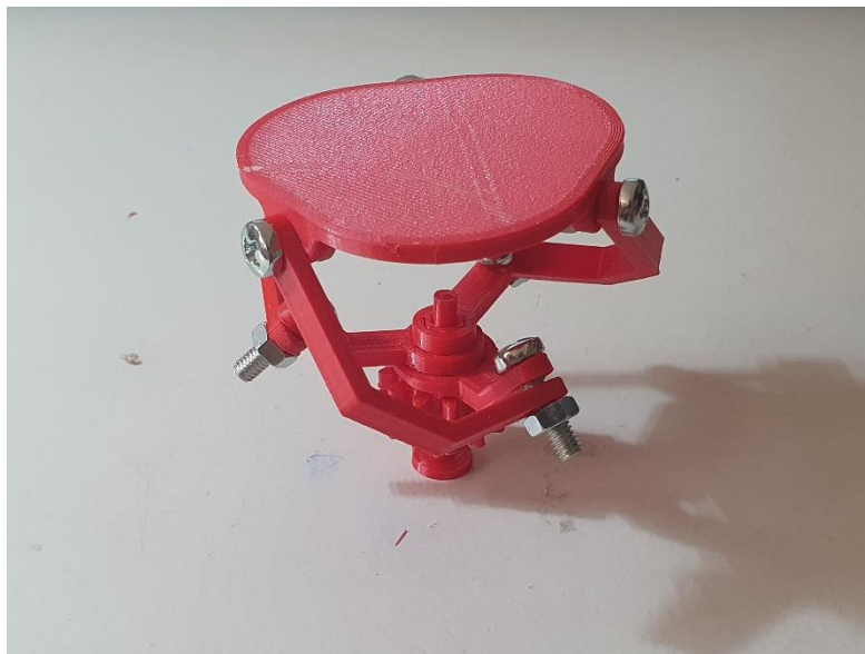
Ilustración 35: Una de las primeras versiones del mecanismo de la muñeca.
