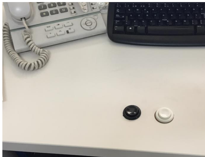
Figura 23 Botones arcade para facilitar la apertura de puertas. (Elaboración Propia, 2020)
