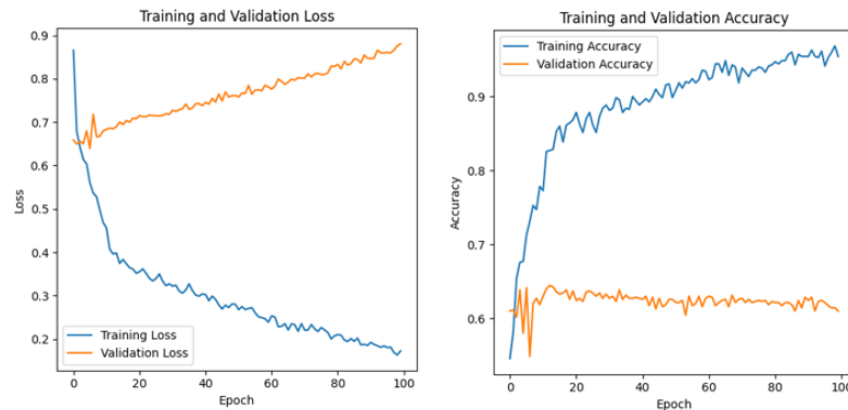
Figura 33. Diagramas del entrenamiento y validación para la pérdida y precisión de MobileNetV2
