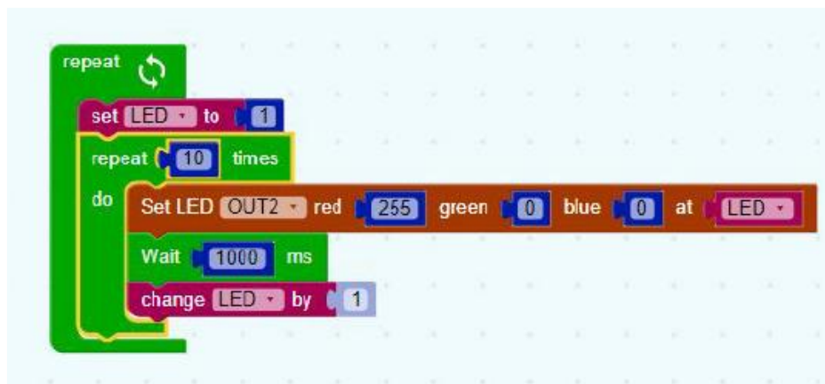
Figura 4 Ejemplo de programación visual por bloques (Fuente: elaboración propia)
