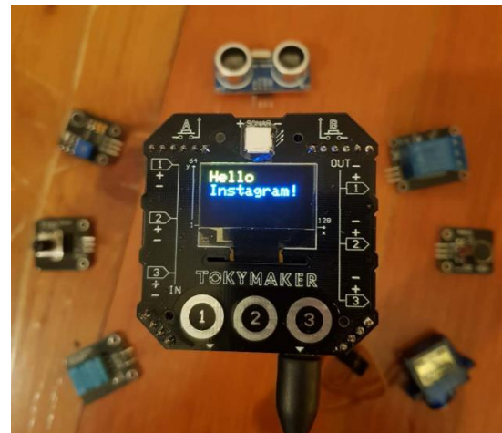
Figura 7 Entradas y salidas del Tokymaker (Fuente: https://tokylabs.com )
