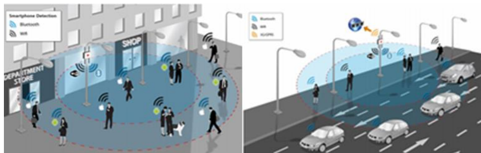
Figura 12. Sistema de detección de dispositivos WIFI y Bluetooth (Libelium, 2018)
