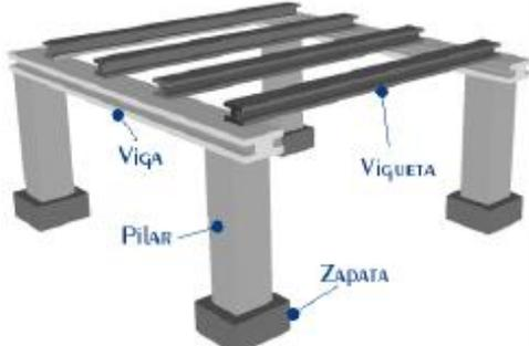
**Fig 6: Zapata, pilar, viga y vigueta.**
