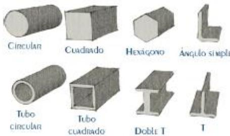
**Fig 10: Secciones de diferentes perfiles.**
