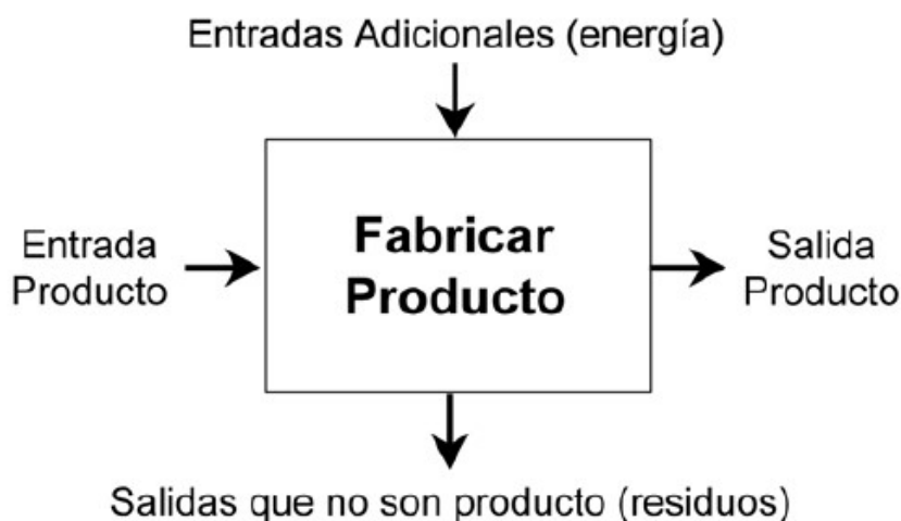
Figura 7. Ejemplo de un diagrama de entrada y salida para un paso en la operación de manufactura (U.S Environmental Protection Agency, 2014)
