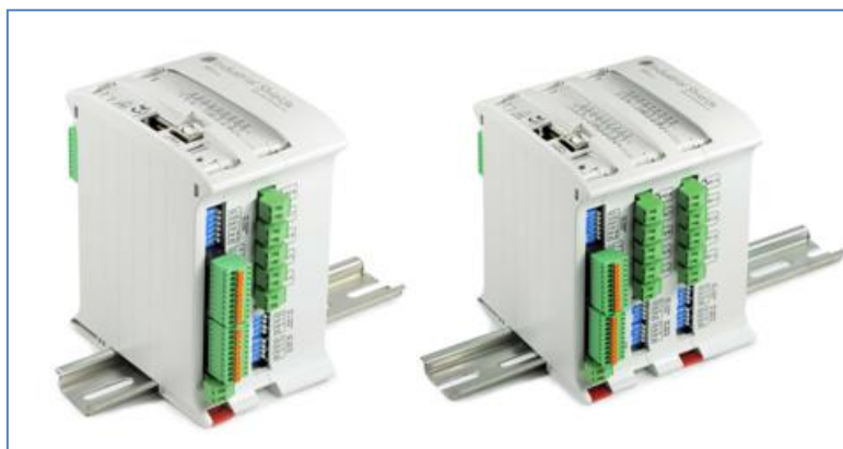
Figura 6: PLCs industriales basados en ARDUINO (Industrial Shields, 2016)
