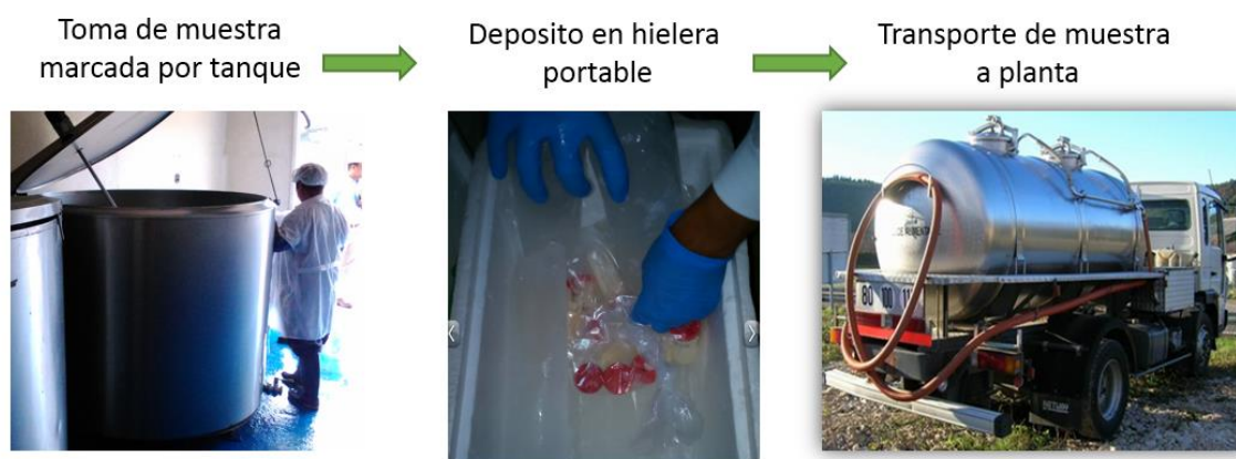
Ilustración 3: Toma de muestra a tanques comunitarios
