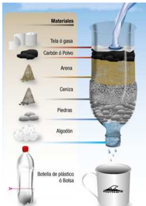
Figura 4: Ejemplo de posible diseño de filtro casero (Fuente: http://www.montgne.com.ar )
