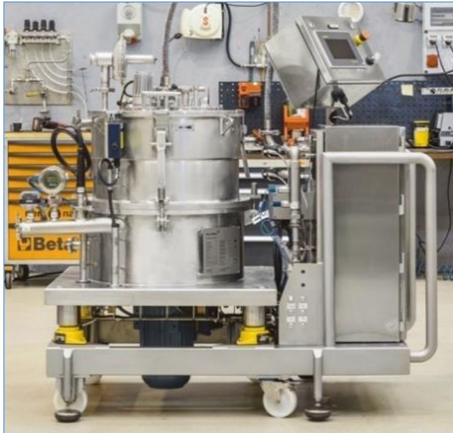
Figura 4. Imagen de una centrifuga de filtros de la empresa española Riera Nadeu.
