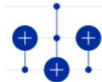
Figura 2.18: Implementación de la puerta Toffoli que ofrece la plataforma IBM Quantum. Esta es el diseño que se utilizará si utilizamos la puerta Toffoli incluida en dicha plataforma.
