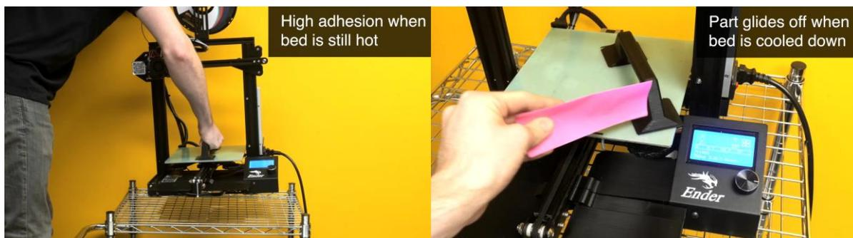
*Nota: Esta figura muestra una comparativa de la fuerza requerida para despegar una pieza de la cama de impresión caliente y fría. Adaptada de 3DQue, 2022
