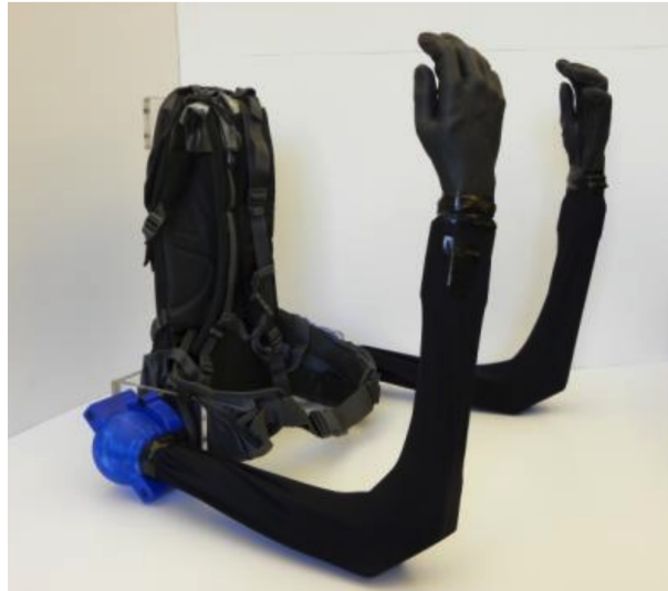
Figure 7: Co-robot para ofrecer apoyo a operarios Fuente: Imagen proveniente del trabajo de (Llorens et al., 2012)
