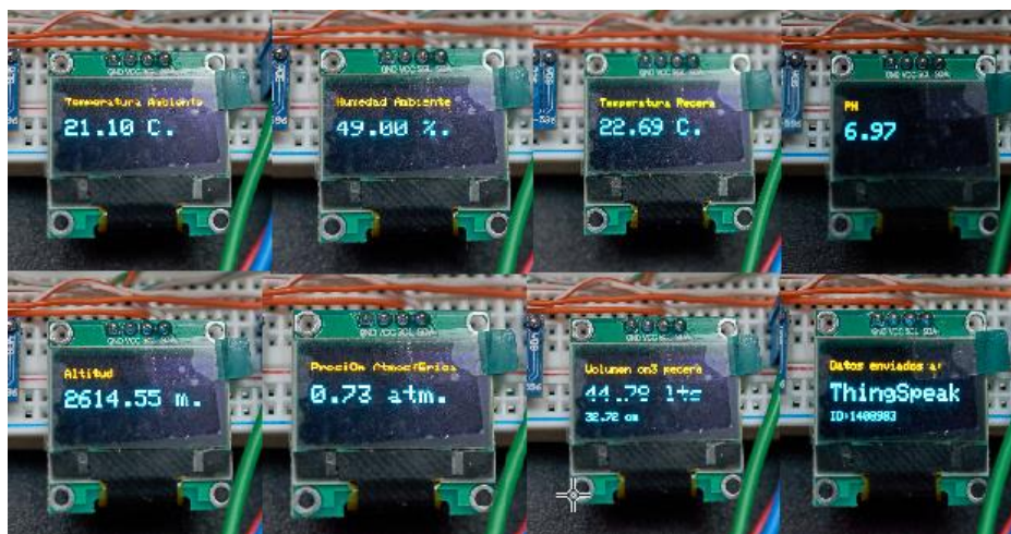
Figura 46. Datos presentados en pantalla OLED. (Creación propia)
