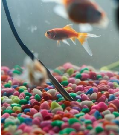
Figura 28. Sonda DS18B20 sumergida. (Creación propia)
