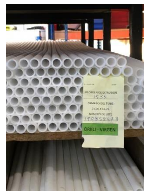
Figura 28. Tubo rectificado almacenado (Fuente: elaboración propia en Bexiflon)
