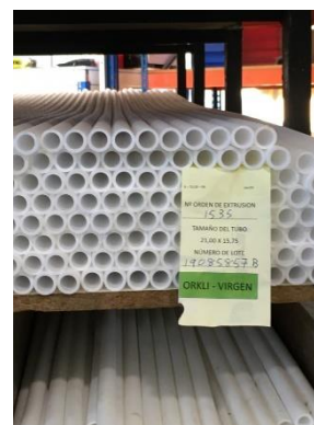
Figura 26. Tubo extrusionado almacenado (Fuente: elaboración propia en Bexiflon)
